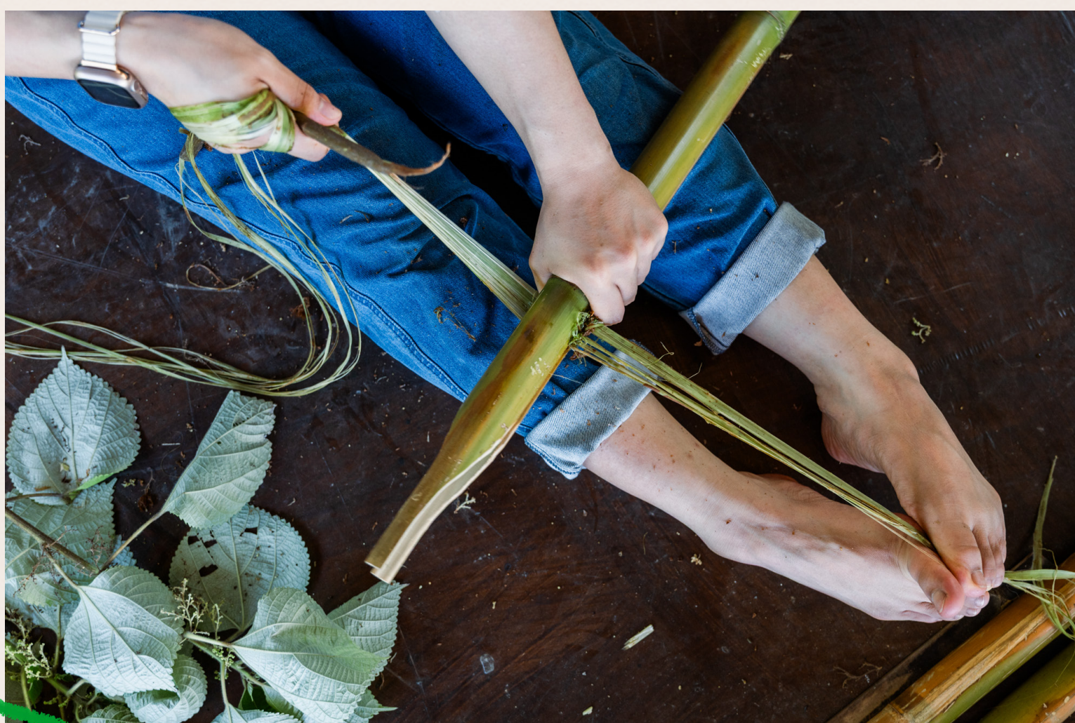
⑤ 苧麻 | 以竹製刮麻器將苧麻莖的粗皮與膠質刮除，留下纖維 ⑥ 黃藤 | 採下來的黃藤要剖片、刨整後才能開始編織
